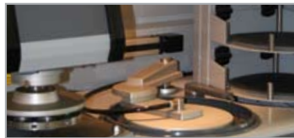
SCHLEIFSTATION MIT FOLIEN-WECHSLER UND FOLIENMAGAZIN
